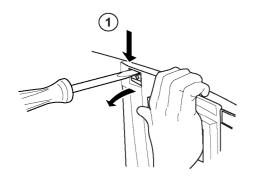
С помощью отвертки нажмите на защелку слева и потяните левую часть лицевой поверхности до ее освобождения.
