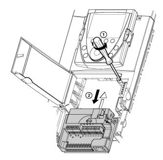
Для облегчения монтажа цепей управления ПЧ блок клеммников управления может быть снят.
