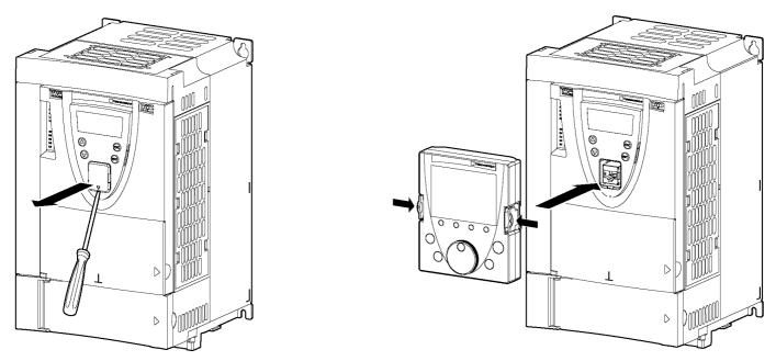
Графический терминал может устанавливаться и сниматься под напряжением.
