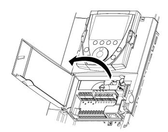
Для доступа к клеммникам цепей управления откройте крышку лицевой панели управляющей части ПЧ.
