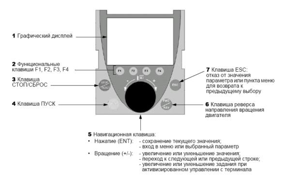
Доступ к параметрам преобразователя частоты и их настройка осуществляется путем использования вращающейся клавиши навигатора и кнопки «Esc».
